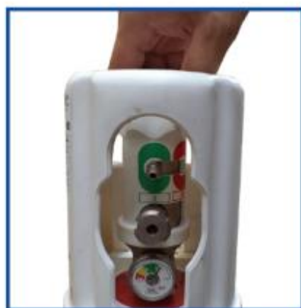
3) Le robinet fermé, vérifier le passage de la position verte à la position rouge
